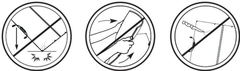
太阳能板内含玻璃，以上损害太阳能板的行为，会导致太阳能板玻璃碎裂及功率下降，甚至造成损坏。人为损坏、不正确使用对太阳能板造成的损坏，均不属于免费保修范围。
