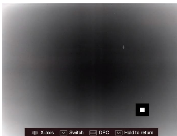
Рис. 3-2. Коррекция дефектных пикселей
