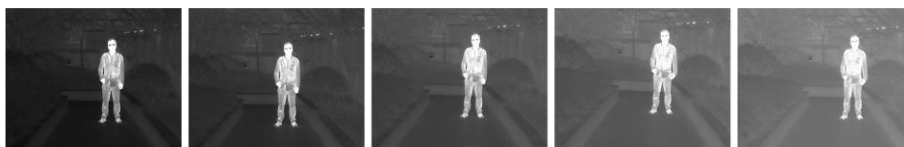
Рис. 3-1. Регулировка яркости в режиме «горячее – белое»
