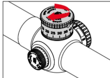
Les corrections latérales se font de manière analogue: si le point d'impact est à droite (tir à droite), tourner la molette (5b) dans le sens inverse des aiguilles d'une montre,
