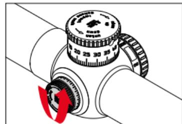
7. Una vez efectuada la corrección, vuelva a realizar un disparo de prueba. Si la posición de la retícula y el punto de impacto coinciden, el arma y el visor están alineados.
