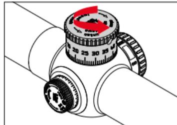
bei tiefer Treffpunktlage (Tiefschuss) im Uhrzeigersinn.
