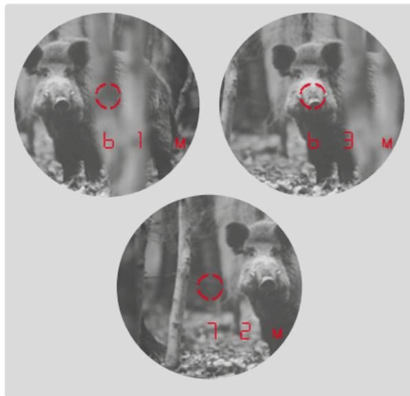
Con Leica Rangemaster è possibile eseguire misurazioni anche a ciclo continuo (modalità Scan): Mantenere premuto il pulsante principale 2 la seconda volta. Dopo circa 2,5 secondi, il dispositivo entra in modalità Scan ed esegue misurazioni a ciclo continuo. La modalità Scan è riconoscibile dall'alternarsi delle visualizzazioni sul display.
