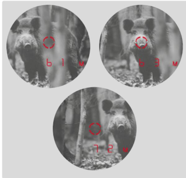
Mit dem Leica Rangemaster kann auch im Dauerbetrieb (Scan-Betrieb) gemessen werden:
