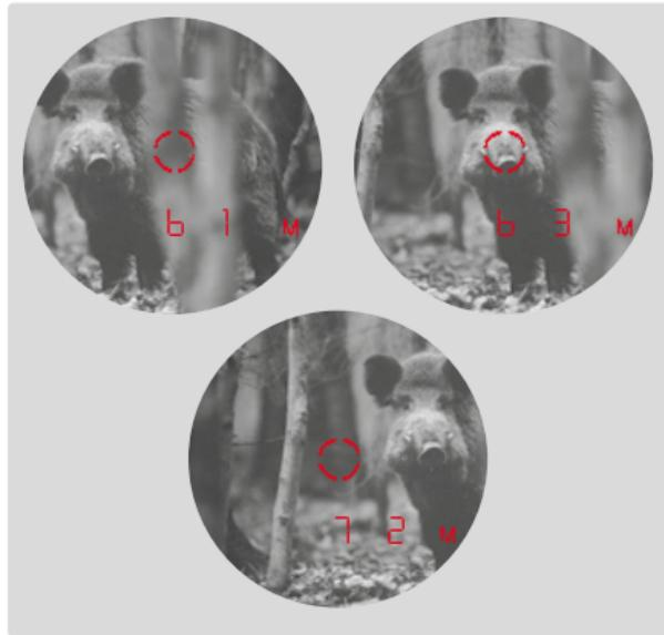
Дальномер Leica Rangemaster позволяет выполнять измерение в режиме постоянной работы (режим сканирования). При втором нажатии удерживайте главную клавишу 2 в нажатом положении. Приблизительно через 2,5 секунд прибор переходит в режим сканирования, и измерения выполняются постоянно. Это можно определить по изменению индикации.
