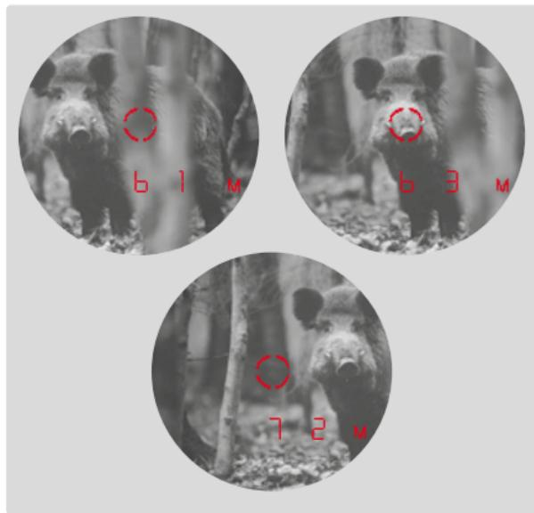
Con el Leica Rangemaster también se puede medir en modo de funcionamiento permanente (modo exploración): Mantenga presionado el botón principal en la 2<sup>a</sup> pulsación. Al cabo de aprox. 2,5 segundos el aparato pasa al modo exploración, realizando entonces mediciones permanentemente. Esto se puede reconocer en que las indicaciones van variando.
