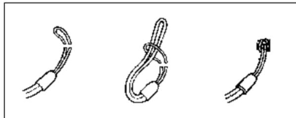
Introduire la petite boucle de la courroie de port dans l'œillet **4** du Leica Rangemaster. Faire passer ensuite l'extrémité du cordon de port dans la petite boucle, puis serrer de manière que le nœud coulant ainsi formé soit bien serré autour de l'œillet du boîtier.
