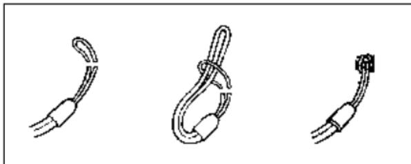
Introduzca el pequeño lazo de la correa de transporte a través de la argolla **4** dispuesta en el cuerpo del telémetro Leica Rangemaster. A continuación, enhebre el extremo del cordón de transporte por el pequeño lazo, y tire con fuerza suficiente para que el lazo formado quede bien fijado a la argolla del cuerpo.
