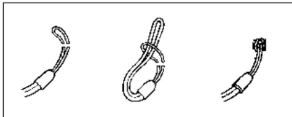
Inserire la piccola ansa della tracolla nell'occhiello **4** sul corpo del Leica Rangemaster. Quindi, infilare l'estremità della tracolla nella piccola ansa e stringere il cappio risultante sull'occhiello in modo da assicurare saldamente la tracolla al corpo del dispositivo.
