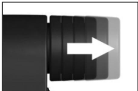
Um störendes Streulicht zu reduzieren, ist das MINOX Macroscopic am Okular mit einer Drehaugenmuschel ausgestattet.
