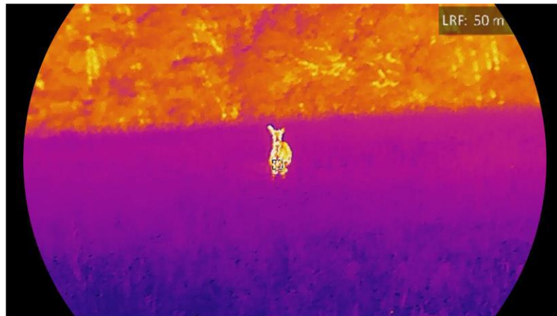
Рисунок 4-1 Результат вимірювання відстані лазером
