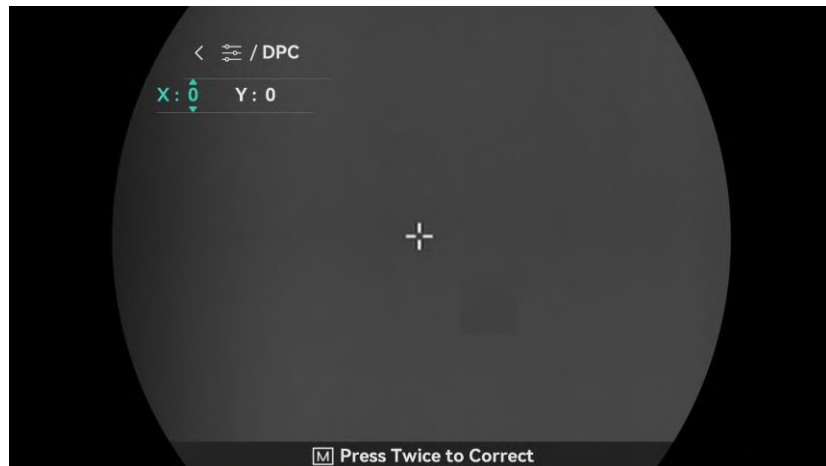
Рисунок 3-6 Коригування дефектних пікселів
