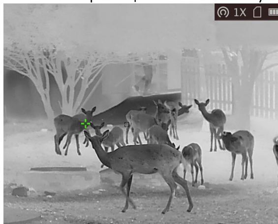
Рис. 5-1. Отслеживание горячих точек
