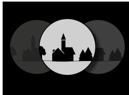
Индивидуальная настройка расстояния между глазами достигается сгибом по шарнирной оси. При правильной настройке расстояния между зрачками поля зрения справа и слева сливаются в единое изображение круглой формы.
